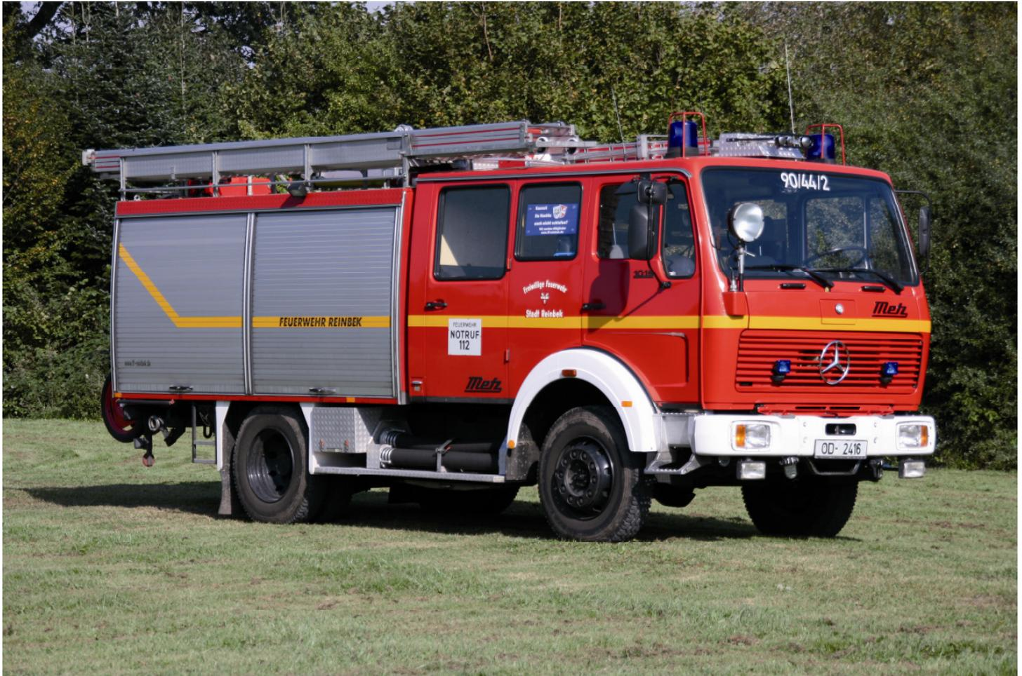
LF 16 Löschgruppenfahrzeug 16 - Fahrgestell: MB 1019 AF - Aufbau: Metz - Baujahr: 1981 - Löschwassertank: 1600 l
