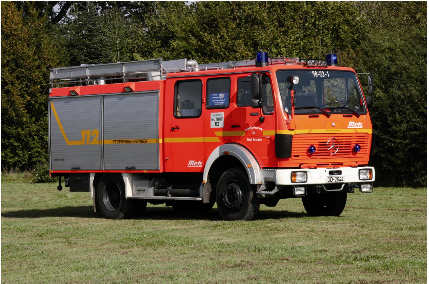
Tanklöschfahrzeug TLF 16/25 - Fahrgestell: MB 1222 AF - Aufbau: Metz Baujahr: 1987 - Löschwassertank: 2400 l
